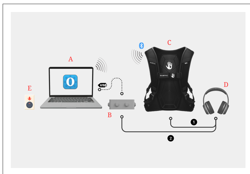
FIGURE 9.1 – Schéma du dispositif expérimental, avec : (A) le logiciel OpenSesame fonctionnant sur ordinateur; (B) le générateur du stimulus de masquage; (C) le gilet vibrant Subpac M2; (D) le casque audio Beyerdynamic DT770 Pro; (E) l'émetteur du téléavertisseur. La connexion du casque audio peut être permutée manuellement entre (1) le gilet vibrant et (2) le générateur du stimulus de masquage. La connexion entre la source du signal audio (ordinateur) et le gilet vibrant est assurée en Bluetooth.
