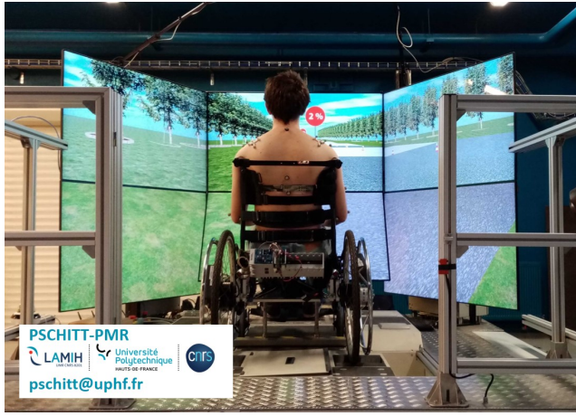
FIGURE 1. Sujet équipé installé dans le simulateur PSCHITT-PMR (écrans, bancs à rouleaux, FRM instrumenté).
