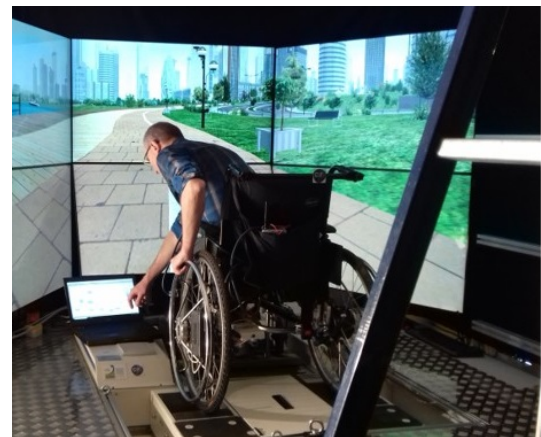
Figure 1: Image of the PSCHITT-PMR simulator ( Plateforme de Simulation Collaborative, Hybride, Intermodale en Transports Terrestres – Personne à Mobilité Réduite )
