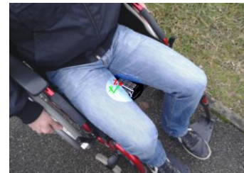
Fig. 2. Emplacement du Smartphone et axe de mesure.
