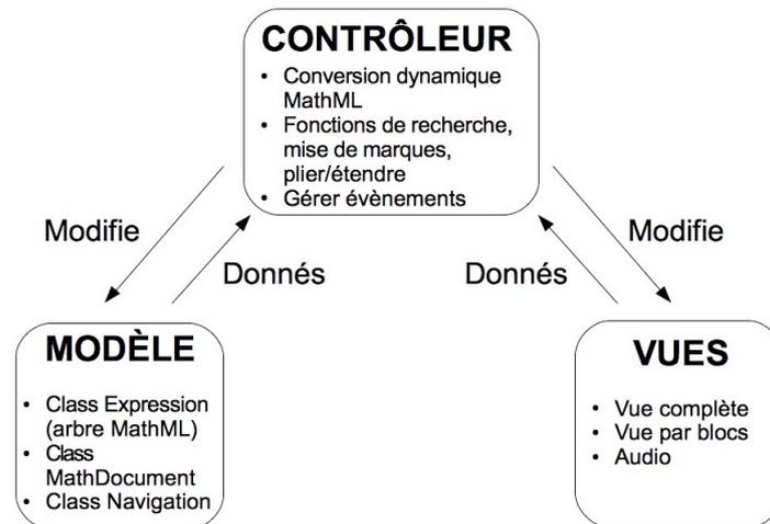
FIGURE 7.1 – Modèle-Vue-Contrôleur (MVC).
