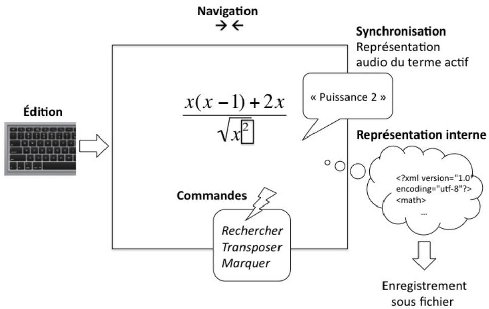
FIGURE 6.4 – Diagramme de fonctionnement de l'interface.
