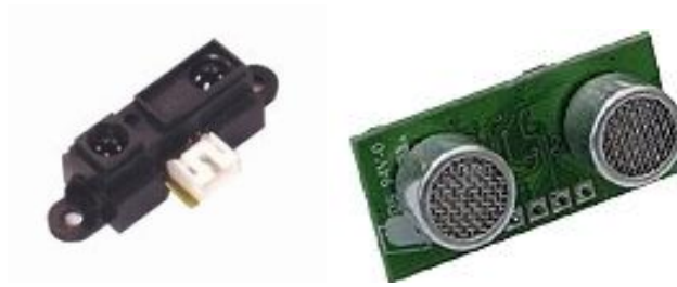
Fig. 1.5 : Télémètre Infrarouge IR (a), Télémètre Ultrason (b).
