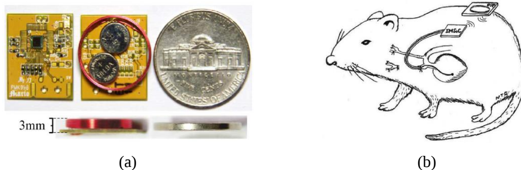
Figure 3-17: (a) Prototypage de pacemaker miniature et (b) schéma d'implantation sur un rat. (© 2011 IEEE, [110])
