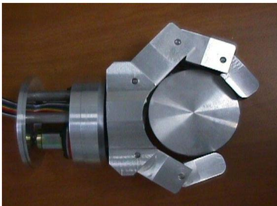
**Figure 2:** Préhenseur R.M.H. à deux doigts et cinq degrés de liberté développé au sein de notre laboratoire.
