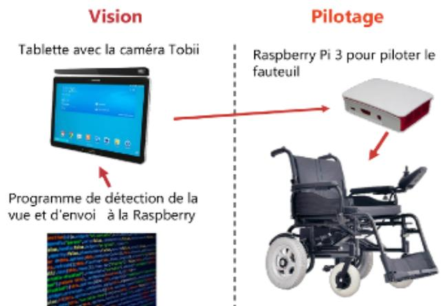
FIGURE 1. Architecture du prototype
