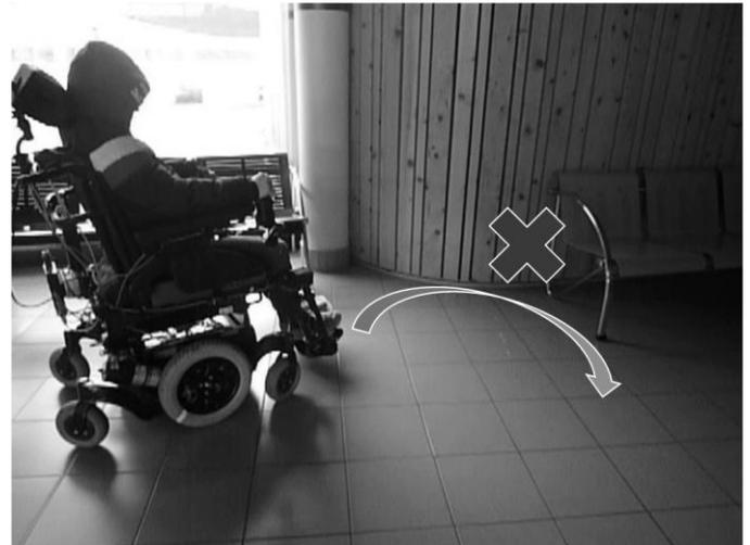
Figure 3 : Détection du mur et rétablissement de trajectoire
