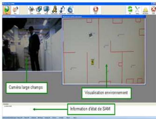
Fig.3 : IHM en mode « plan » pendant le déplacement du robot
