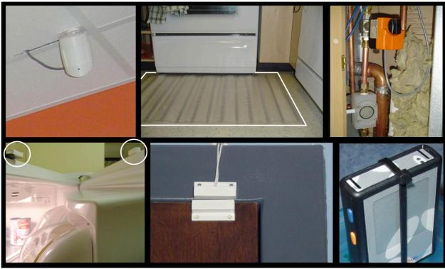
Figure 2. Illustration des capteurs déployés pour le prototype : détecteurs de mouvement, tapis tactiles, débitmètres, contacts électromagnétiques, émetteurs-récepteurs de localisation à ultra large bande
