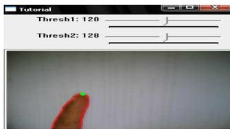
Fig. 2 –Détermination du pic du contour représentant le bout du doigt
