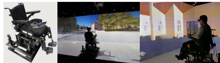
(a) SFRE avec assise et joystick standard. (b) Le SFRE installé en Immersia (scène 3D : crédit Rennes Métropole). (c) Le SFRE installé en Immersia (scène 3D : salle expérimentale du Pôle Saint Hélier)
