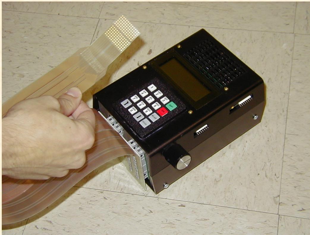
*Le système TDU comprend un boîtier électronique connecté à un câble en nappe se terminant par une matrice d'électrodes*
