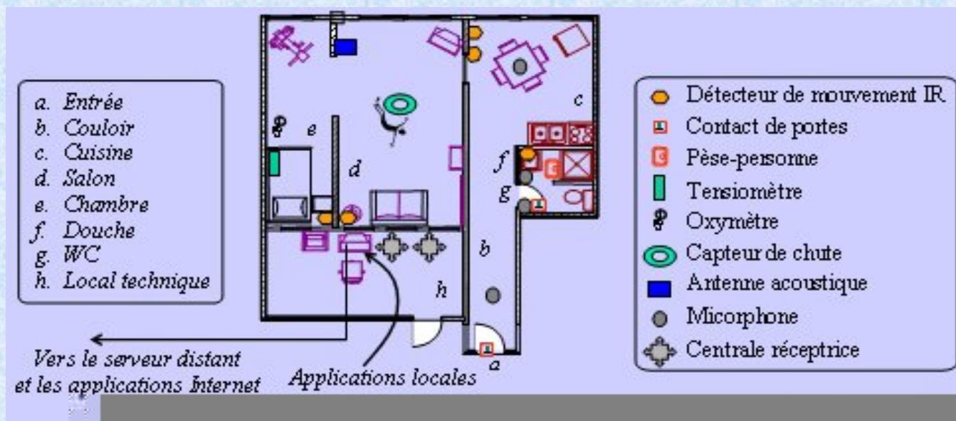
Architecture de l'HIS et disposition des capteurs. © CNRS, TIMC/IMAG
