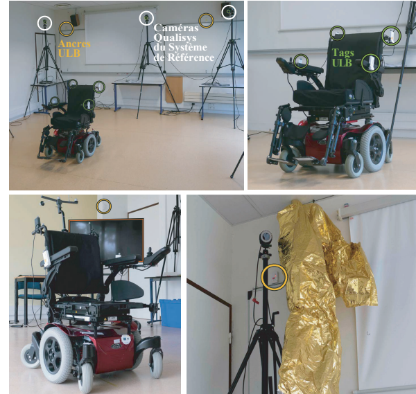
FIGURE 5. Vue d'ensemble de l'environnement expérimental pour la validation de la méthode de positionnement, dans un environnement dégagé (en haut) et encombré (en bas). Le téléviseur et la couverture de survie sont placés de manière à masquer la ligne de vue directe avec deux des quatre ancres.
